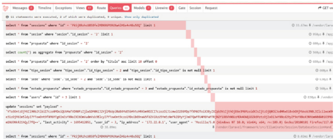
Barra de depuración abierta con la pestaña Queries
